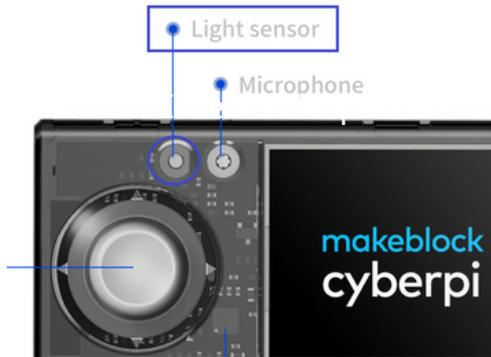
2. Prepara el sensor para que pueda captar un haz de luz direccional. **Recorta** un trozo de papel o post-it **enrollado** y **pégalo orientado** encima del sensor. Manténlo así para el resto del reto:
