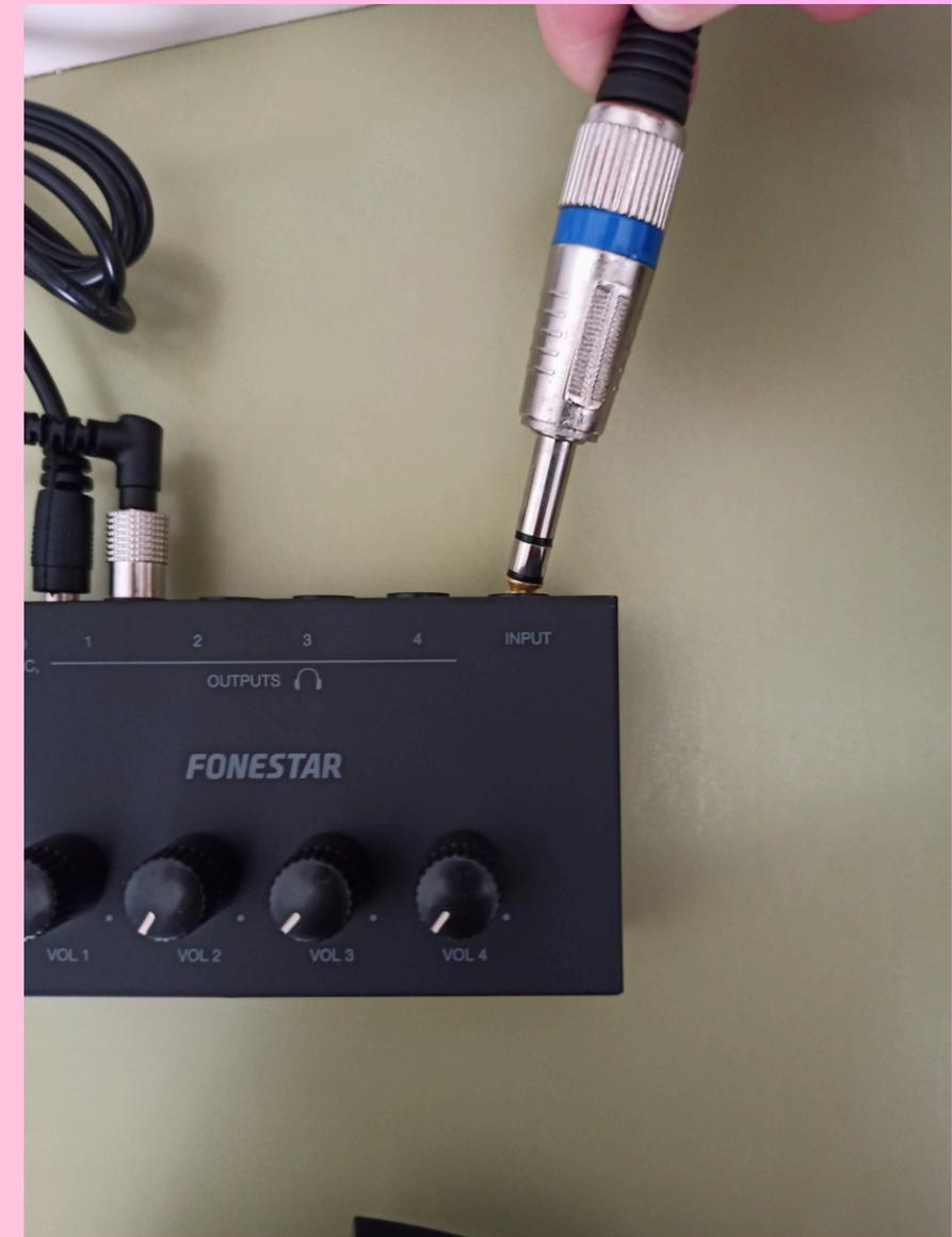
**Cable "Jack" (no "mini jack") para conectar la salida de auriculares (probablemente "Phones") de la mesa mezcladora o tarjeta digital a un distribuidor o amplificadores de auriculares**
