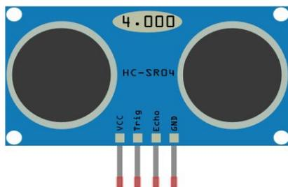
se trata de un dispositivo ultrasónico de bajo coste para determinar distancias cortas de 2cm a 4m con precisión de 3mm. Su determinación se fundamenta en el tiempo que tarda en volver una onda
